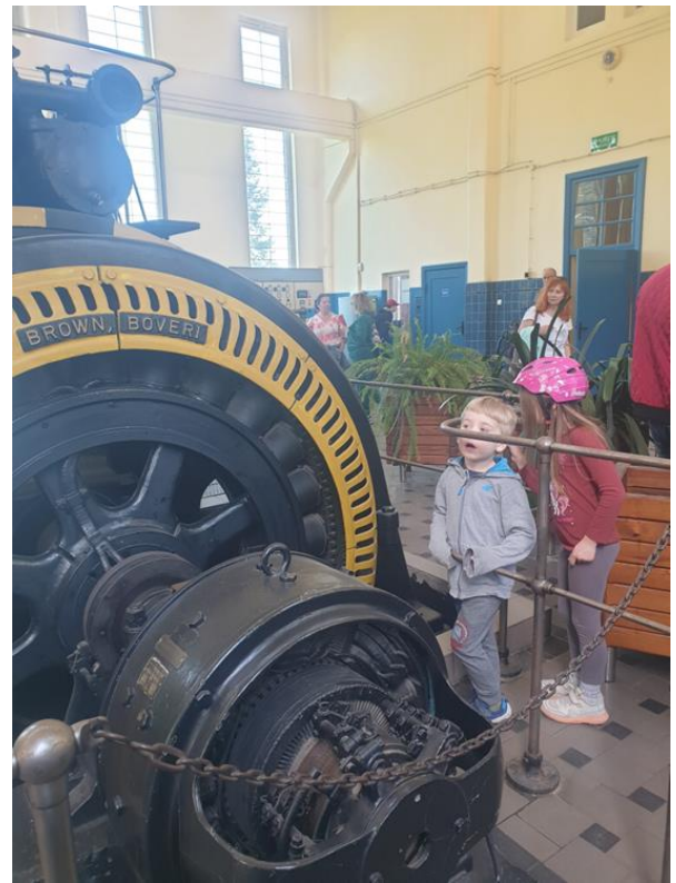
100 letni zabytek techniki szwajcarskiej z 1929 r – sprawny lecz na emeryturze agregat prądowłoczy na potrzeby przepompowni wody – widok wirnika.
